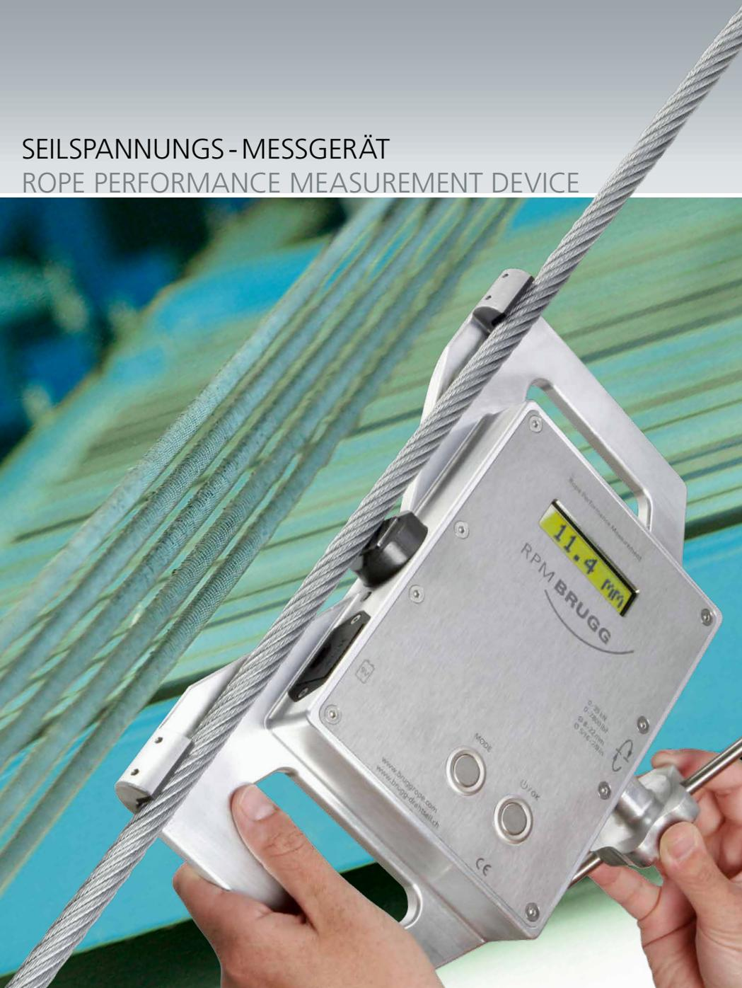
Erst die gleichmässige Seilspannung innerhalb eines Aufzugseilsatzes garantiert einen verschleiss- und wartungsarmen Betrieb und sichert Ihnen so eine hohe Wirtschaftlichkeit und Wettbewerbsfähigkeit. Bei der Seilspannungsmessung bietet das RPM folgende Vorteile:
